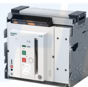
Switch-Disconnecter · DC : up to 100 kA/1 s, 4,000 A
